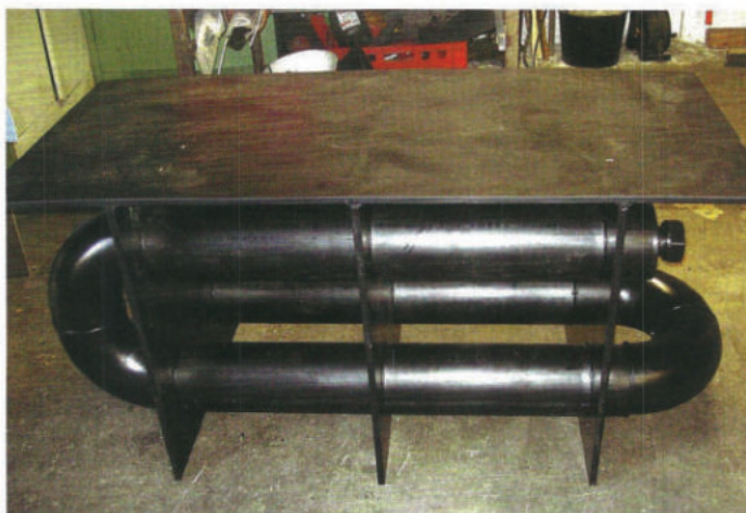
Biofilmreaktor mit Auflageplatte zur Installation der mechanischen Stufe; in den PE-Rohren befindet sich der auf einer großen Oberfläche angesiedelte Biofilm.
